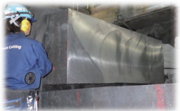
非鉄金属（難切削材）の切断
