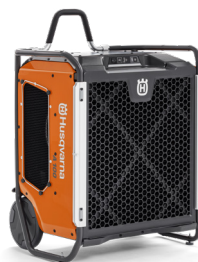
電動式 HUSQVARNA A 45 0.5 kW、230 V、単相、 2.3 A、1,000 m³/h、 20 kg、IP54。
