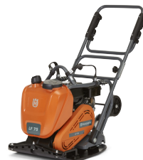
ガソリン式 HUSQVARNA LF 75 LAT 3.6 kW、420～500 mm、95～97 kg、 遠心力 15 kN。
