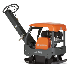
ディーゼル式／ガソリン式 HUSQVARNA LG 204 3.1～4.3 kW、500 mm、211～244 kg、 遠心力 36 kN。
