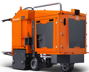
電動式 HUSQVARNA BMP 4000RC リモート制御式。30 kW、400 V/63 A、剥離幅 400 mm、シェービング幅 380 mm、1,550 kg。
