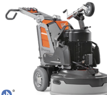
電動式 HUSQVARNA PG 8 DR 16.5 kW、380～415 V、三相、 研磨幅 800 mm、研磨ディスク 3 × 270 mm、661 kg。
