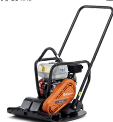
ディーゼル式／ガソリン式 HUSQVARNA LFV 100 3.2～3.6 kW、500 mm、91/101 kg (ガソリン式／ディーゼル式)。遠心力 17 kN。
