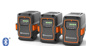
バッテリー HUSQVARNA B140X/B220X/B330X IPX4 等級の堅牢設計によりあらゆる天候 に対応。アクティブ冷却システムにより、 使用中も充電時も最適な温度を維持しま す。4/6/9 Ah、1.3/1.4/1.9 kg。
