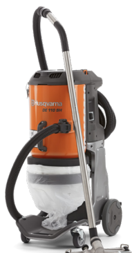
電動式 HUSQVARNA DE 110 SH 0.9 kW、230 V、単相、4 A、 215 m³/h、25 kg、IP54。
