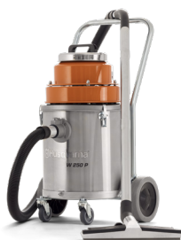
電動式 HUSQVARNA W 250 P 1.55 kW、230 V、単相、5.2 A、 160 m³/h、26 kg。
