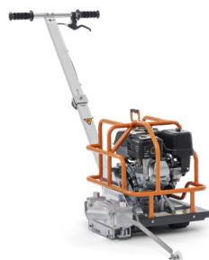
ガソリン式 HUSQVARNA SOFF-CUT 150 ダイヤモンドブレード最大 165 mm、 最大切断深度 38 mm、40 kg、3.5 kW*。
