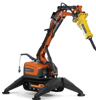
HUSQVARNA DXR 305 27 kW、2,050 kg、到達範囲：上方最大 5.2 m／前方最大 4.9 m（ツールを含む）。
