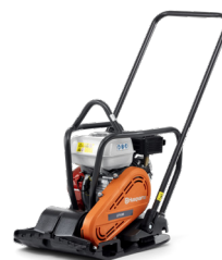
ガソリン式 HUSQVARNA LFV 80 3.6 kW、420 mm、80 kg、 遠心力 19 kN。
