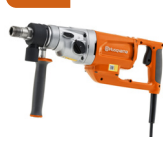
電動式 HUSQVARNA DM 210 SP 2,000 W、単相、推奨ドリル径： コンクリート 150 mm 未満、石 材 202 mm 未満、(80 mm / 手持ち時)、6.5 kg。
