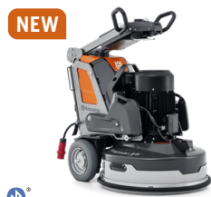
電動式 HUSQVARNA AUTOGRINDER™ 自走式。16.5 kW、380～415 V、三相、 研磨幅 800 mm、研磨ディスク 3 × 270 mm、661 kg。
