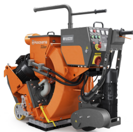
電動式 HUSQVARNA BLASTRAC 2-20DT 2 × 11 kW、400 V、63 A、作業速度 0.5 ~ 33 m/min、作業幅 550 mm、575 kg。
