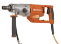
電動式 HUSQVARNA DM 200 2,000W、単相、推奨ドリル 径 25~100 mm、6.4 kg。
