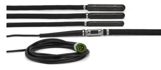
電動式 HUSQVARNA VIBRASTAR 42 V、三相、200 Hz、 \phi 40 \sim 60 mm、ホース の長さ 5 m、8.4~15 kg。
