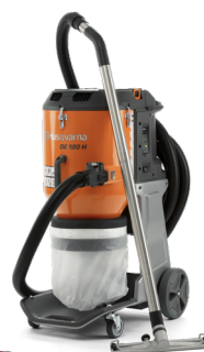
電動式 HUSQVARNA DE 120 H 2.2 kW、230 V、単相、15 A、 480 m³/h、39 kg、IP55。
