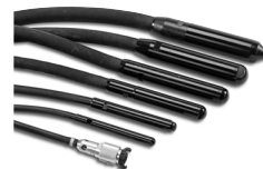
空圧式 HUSQVARNA AY シリーズ 直径 (5 種類) 35~105 mm、ホースの長さ 4 m、4~28 kg。
