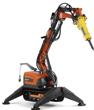
HUSQVARNA DXR 315 27 kW、2,110 kg、到達範囲：上方最大 5.5 m／前方最大 5.2 m（ツールを含む）。
