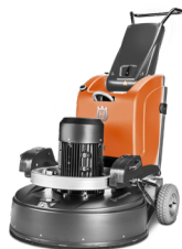
電動式 HUSQVARNA HTC 950 RX 15 kW、380～415 V、三相、 研磨幅 920 mm、研磨ディスク 4 × 270 mm、600 kg。
