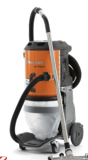
電動式 HUSQVARNA DE 110 H 1.1 kW、230 V、単相、5 A、 240 m³/h、25 kg、IP54。
