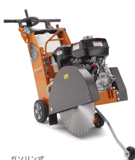
ガソリン式 HUSQVARNA FS 400 LV ダイヤモンドブレード最大 450/500 mm、切断深度 162/189 mm、99/120 kg、 8.7 kW*。
