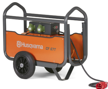
電動式 HUSQVARNA CF 67T 出力 42 V、三相、200 Hz、4.7 kVA、 67 A、70 kg、コンセント × 4。
