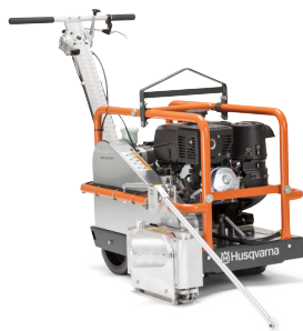
ガソリン式 HUSQVARNA SOFF-CUT 2000 ダイヤモンドブレード最大 250 mm、 最大切断深度 38 mm、144 kg、6.5 kW*。
