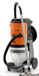
電動式 HUSQVARNA DE 110 H 1.1 kW、230 V、単相、5 A、 240 m³/h、25 kg、IP54。
