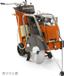
ガソリン式 HUSQVARNA FS 500 シリーズ ダイヤモンドブレード最大 600/500 mm、切断深度 241/179 mm、231/197。FS 524、ガソリン式、15.5 kW*。 FS 513、ガソリン式、8.7 kW*。
