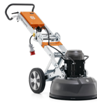
電動式 HUSQVARNA PG 510 4.0～2.2 kW、400～220 V、三相／単相、 研磨幅 515 mm、研磨ディスク 3 × 230 mm、133/120 kg。
