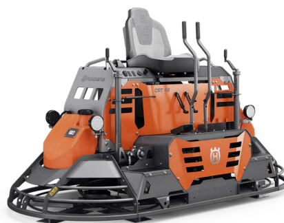
ガソリン式 HUSQVARNA CRT 48 PS 1,000~2,500 m 2 の床面仕上げに最適。パワーステアリングにより正確な操作が可能で、疲労を大幅に軽減します。また、変化する現場の状況に合わせて選択できる 2 つの制御モードを装備しています。 42.5 kW、2 × 1,220 mm、660 kg。
