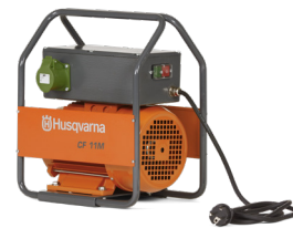
電動式 HUSQVARNA CF 11 出力 42 V、三相、200 Hz、0.8 kVA、11 A、 18 kg、コンセント × 1。
