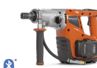
コアドリル HUSQVARNA DM 540i 1,350 W、推奨ドリル径 15~75 mm (100 mm/ドリルスタンド使用時)、4.9 kg。
