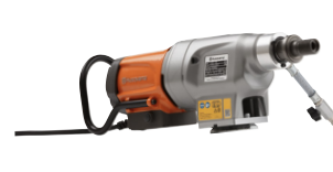
電動式 HUSQVARNA DM 430 3,200W、単相、推奨ドリル径 100~450 mm、15.5 kg。
