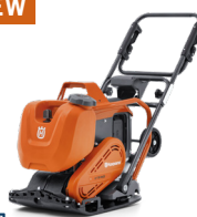
NEW バッテリー式 HUSQVARNA LF 75 PACE 1.3 kW、420 mm、85 kg (バッテリーを除く)、遠心力 15 kN。
