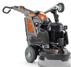
電動式 HUSQVARNA PG 6 DR 12.5 kW、380～415 V、三相、 研磨幅 640 mm、研磨ディスク 3 × 270 mm、591 kg。
