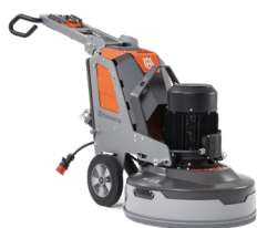
電動式 HUSQVARNA PG 8 S 11 kW、380～415 V、三相、 研磨幅 800 mm、研磨ディスク 3 × 270 mm、508 kg。
