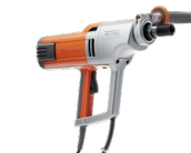
電動式 HUSQVARNA DM 230 1,850 W、単相、推奨ドリル径 150 mm (80 mm / 手持ち時)、7 kg。
