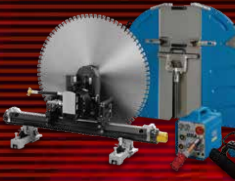
湿式ハイスサイクルウォールソー ハイドロストレス WSE1621:20kW 水冷モータ用冷却水がウォール ソーヘッドを通過してリターンで きる湿乾兼用モデル。 乾式に最適な周速条件。 オプション:乾式専用カバー発売予定
