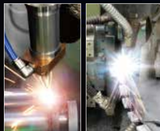
レーザー溶接 セグメントと基板・台金を最新のレーザー溶接機で接合。
