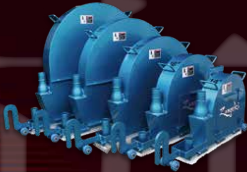
Zangeki乾式カバー ブレードサイズ別 14・18・22・26・30in ※30in:501・505専用 標準 2か所の粉塵吸引で 異なる方向の切削粉を集塵。
