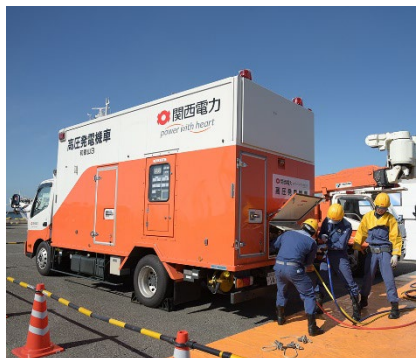
高圧発電機車応急送電用ケーブルにより停電中の建物へ応急送電
