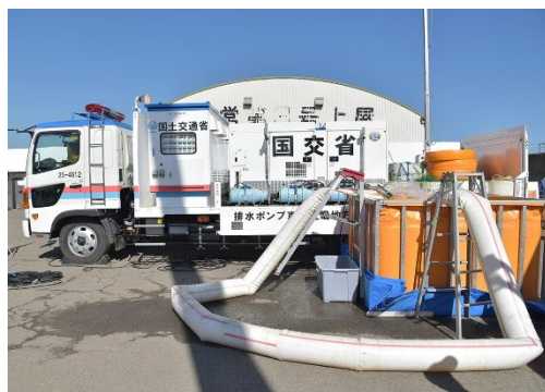
国土交通省排水ポンプ車
