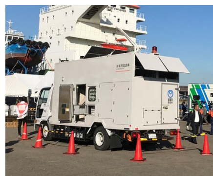
西日本電信電話(株)和歌山支店 移動電源車
