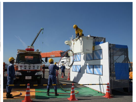
高圧発電機車応急送電用ケーブルにより停電中の建物へ応急送電
