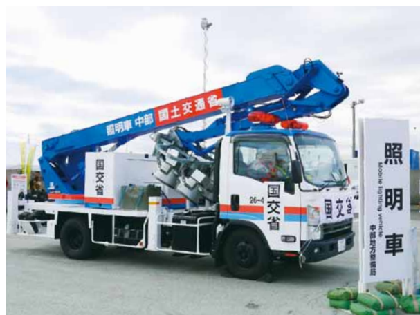
照明車 (中部地方整備局)
